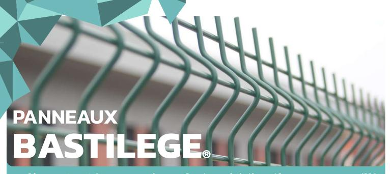
La clôture BASTILEGE® est un système complet breveté indémontable. Panneaux en treillis soudés, fils galvanisés Z275 et plastifiés diam 4mm, picots défensifs 30mm, mailles de 100 x 55mm pour panneau de longueur 2.50m Les panneaux BASTILEGE® sont renforcés par des plis horizontaux donnant ainsi sa très grande rigidité à la clôture.
