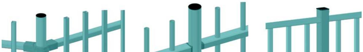
Pose en angle possible pour les poteaux ronds, pour les poteaux carrés, doubler les poteaux si angle  $\neq 90^\circ$ .
